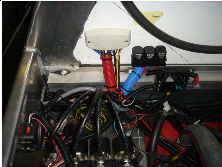
Pneumatiikka-Magneettiventtiilit vasemmassa konsolissa
